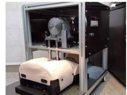
누르고 마네킹의 내구성을 테스트하는 모습
